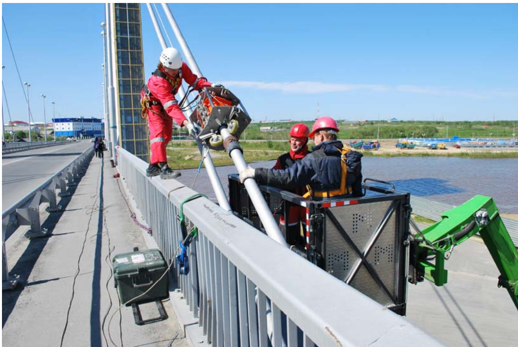
Рисунок 3 - Установка дефектоскопа на канат
